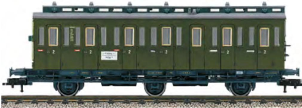
Die Bauform der Abteilwagen stammt noch aus der Anfangszeit der Eisenbahn. Die Bauart „pr 11“ ist eine der letztgebauten preußischen Abteilwagen mit Oberlichtdach und gleichzeitig meistgebauter Reisezugwagen auf deutschem Boden. Die drei- bzw. zweiachsigen Wagen gab es mit und ohne Bremserhaus. Einige Exemplare sind noch heute bei Museumsbahnen hinterstellt.
