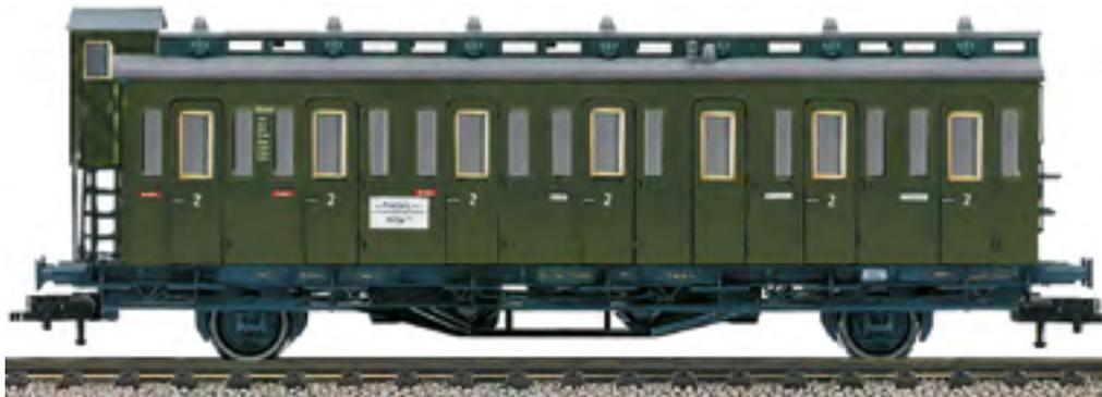
Die Bauform der Abteilwagen stammt noch aus der Anfangszeit der Eisenbahn. Die Bauart „pr 11“ ist eine der letztgebauten preußischen Abteilwagen mit Oberlichtdach und gleichzeitig meistgebauter Reisezugwagen auf deutschem Boden. Die drei- bzw. zweiachsigen Wagen gab es mit und ohne Bremserhaus. Einige Exemplare sind noch heute bei Museumsbahnen hinterstellt.
