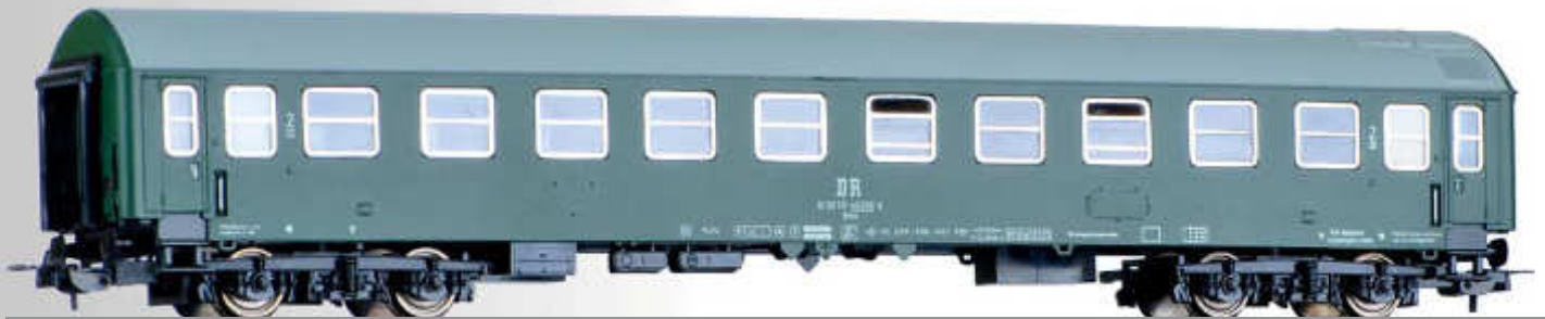
Reisezugwagen 2. Klasse Bme, Typ B, der DR (Längenmaßstab 1:100) 2nd class passenger coach Bme, type B, of the DR (length scale 1:100)
