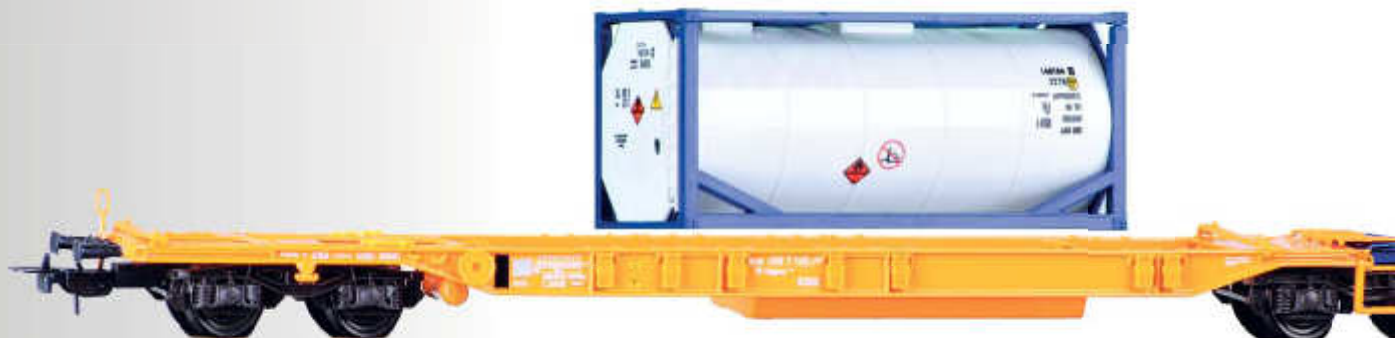
Doppeltragwagen Sdggmrs 744 „Kombiwaggon“ der DB AG mit Beladung einem 40' Container und einem 20' Tank-Container
