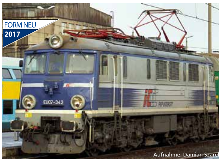
96374 Elektrolok EU 07-342 PKP IC Ep. V, mit Blitzableiter und Hubpuffer
