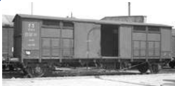
Gedeckter Güterwagen der Italienischen Staatsbahn. Gruppe EE, Modell der langen Bauart, Bj. 1937-42.
