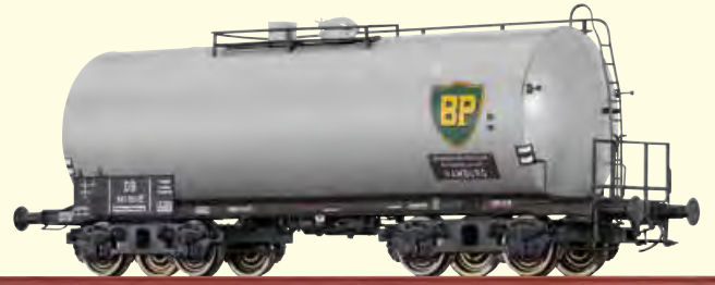
Leichtbaukesselwagen Uerdingen ZZ [P] „BP“ der DB Betriebs-Nr. 581 393 [P]
