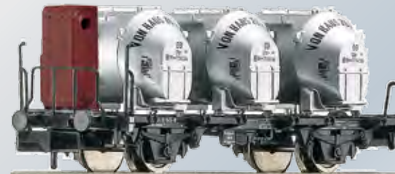
N: Behältertragwagen Bauart Bt10 mit Blechbremserhaus, Epoche III
