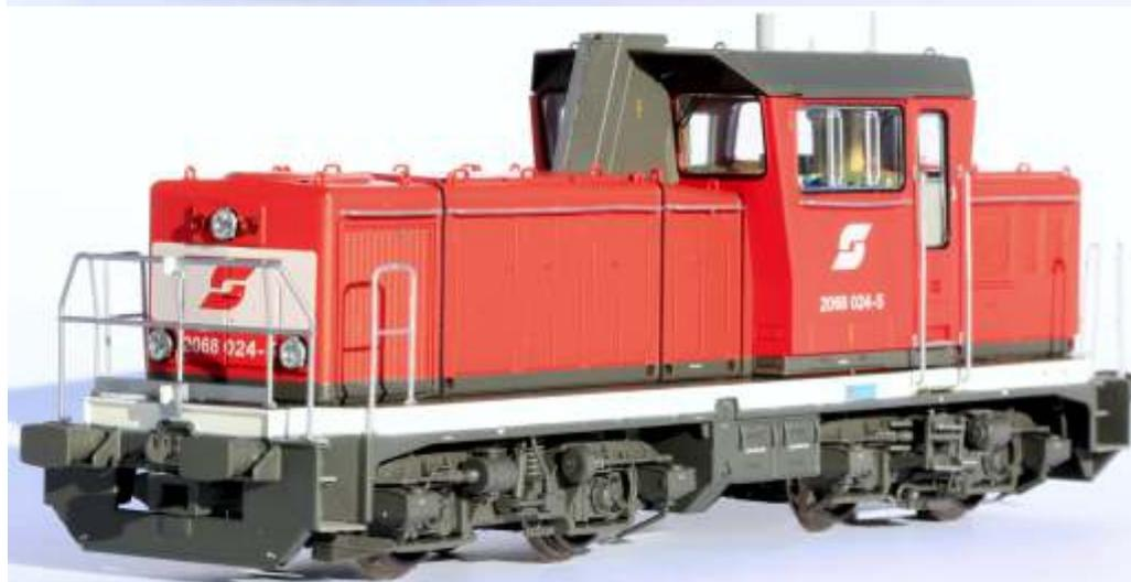
Die Hauptserie weist gegenüber den fünf Prototypen geringfügige Unterschiede auf. Die Vorserienloks wurden 1998 für den Raffinerieeinsatz auf den Werksbahnen der OMV explosions sicher gestaltet. Die Baureihe 2068 wird im Verschubdienst auf größeren Bahnhöfen, vor Nahgüterzügen und zur Bedienung von Anschlussbahnen eingesetzt.
