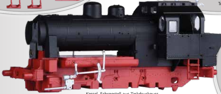
Kessel, Fahrgestell aus Zinkdruckguss
