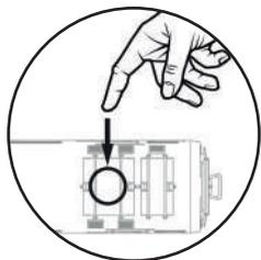
Voiture équipée de éclairage intérieur avec commande tactile pour activer et varier l'intensité
